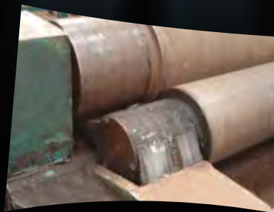
线性导轨:先天性的致命磨损
